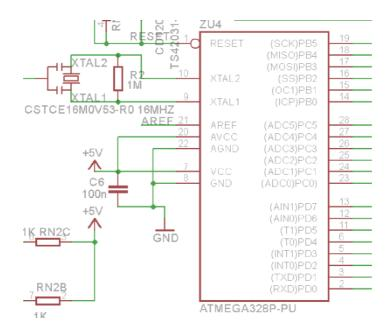
На приведенном фрагменте схемы платы Arduino R3, видно, что тактовую частоту для ATmega328P формирует не кварц, а керамический резонатор фирмы Murata CSTCE16M0V53. Следует отметить, что точность формирования частоты у керамических резонаторов составляет +/-0.50%, что в тысячу раз хуже, чем у кварца, запаянного по соседству. Это означает, что на максимальных скоростях обмена платы Arduino Uno R3 с периферийным устройством возможны потери данных. В общем, странное инженерное решение.
