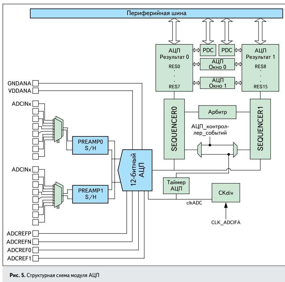
Рис. 5. Структурная схема модуля АЦП
