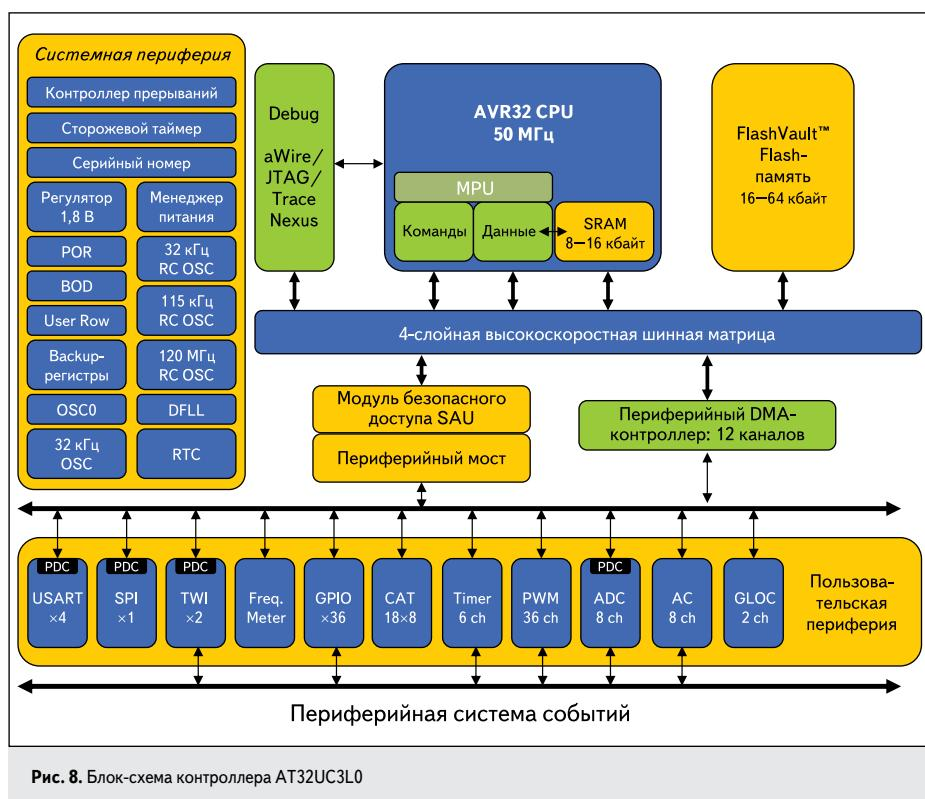
Рис. 8. Блок-схема контроллера AT32UC3L0
