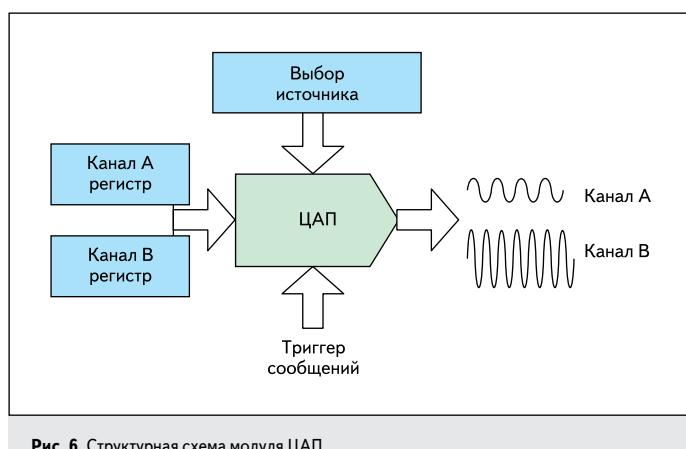
Рис. 6. Структурная схема модуля ЦАП
