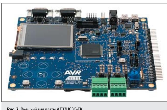
Рис. 7. Внешний вид платы AT32UC3C-EK
