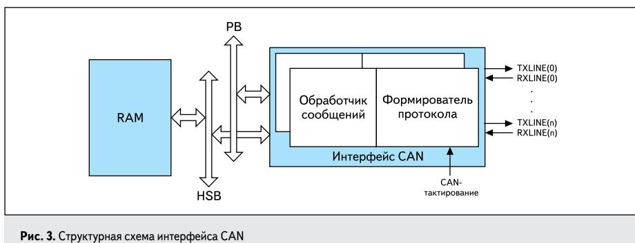
Рис. 3. Структурная схема интерфейса CAN
