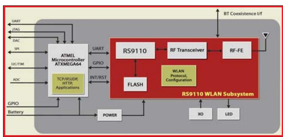
Рис. 5. Структурная схема платы SenSiFi
