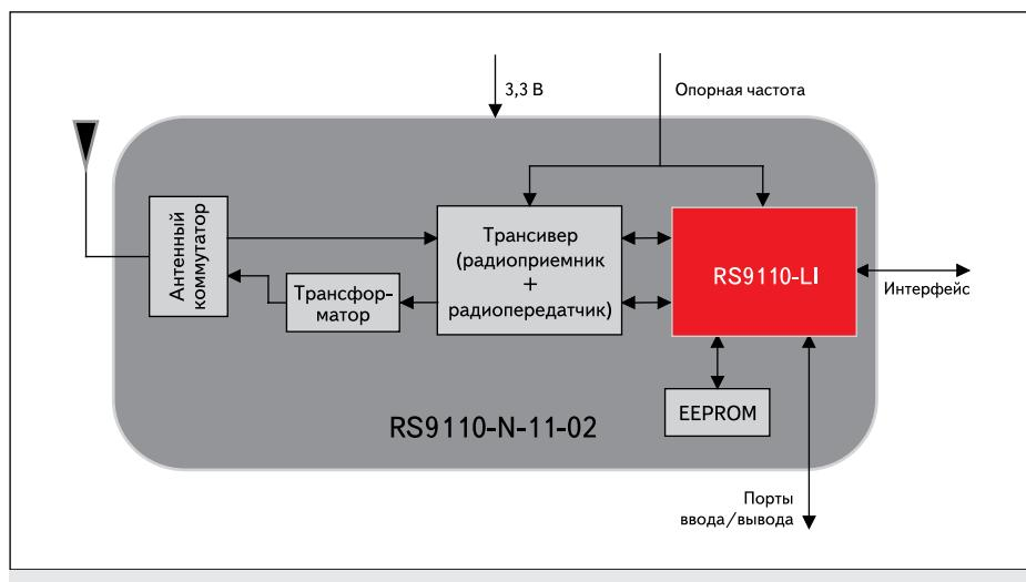
Рис. 1. Структурная схема модуля RS9110-N-11-02
