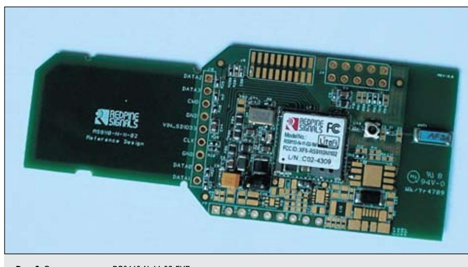
Рис. 3. Отладочная плата RS9110-N-11-02-EVB
